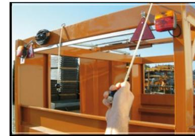
■ Ouverture rapide des portes d'une simple action sur le loquet grâce à un vérin à gaz. (Ouverture télécommandée à distance (30 m) disponible en option)
