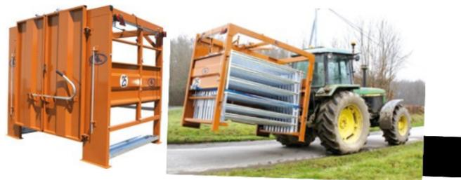
Pratique, sécurisant et mobile, le châssis CPE 0611 permet de transporter jusqu'à 24 barrières ou panels de contention. C'est l'outil idéal pour l'embarquement, le tri ou l'isolement de bovins en plein champs. Les équipements optionnels ci-dessous augmentent sa polyvalence et permettent de pratiquer des soins ponctuels sur de gros bovins en toute sécurité. CPE 0611 est fourni prêt à l'emploi (hors barrières et options).
