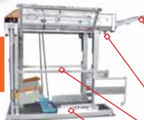
Anti-recul progressif, assisté par vérin à gaz. S'adapte automatiquement en hauteur et longueur au gabarit de l'animal. Permet les fouilles et inséminations.
