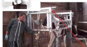
**Treuil arrière horizontal** pour lever les pattes dans l'axe de l'aplomb.
