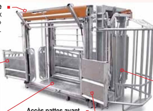
■ **Accès mamelle et pattes arrière** par de larges portillons (95 cm) à double verrouillage : anti-luce (sans goupille) en bas et plat coulissant en partie haute.
