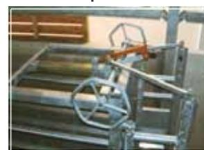
Les deux volants permettent de manœuvrer rapidement les deux battants.
