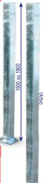
Modèle CFP2000 hauteur 1,50 m et CFP3000 1,90 m à spitter dans le béton (platine 20x20 cm, 4 trous Ø16 mm)
