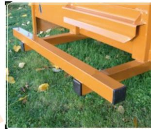
▪ Attelage automatique en tube permettant l'accroche sur la barre du 3 points sans descendre du tracteur. Transport à vide.
